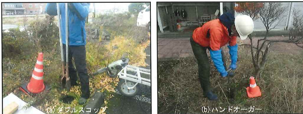
図-4 (a)ダブルスコップ及び(b)ハンドオーガーによる試料採取
