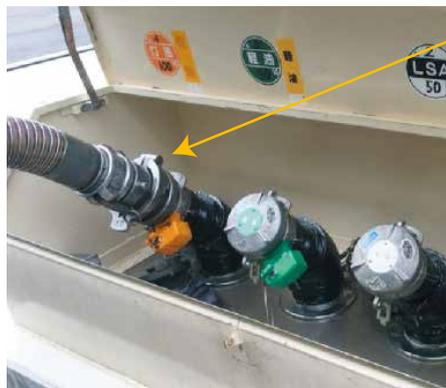
緊結:アダプターで接続(漏れ、可燃性蒸気拡散防止)
